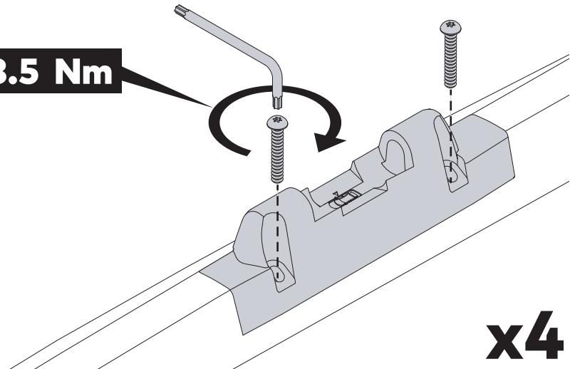
**DE** Bringen Sie mit dem Drehmomentschlüssel 2 Schrauben an, um jedes Landing Pad zu sichern. Vollständig mit 3,5 Nm festziehen.
